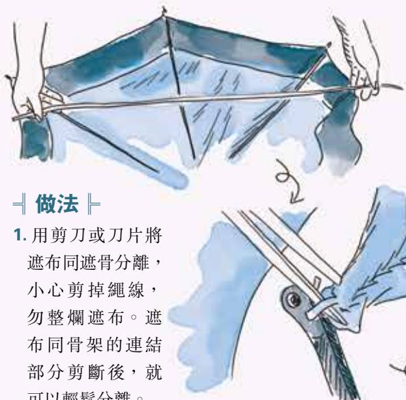
1. 用剪刀或刀片將遮布同遮骨分離，小心剪掉繩線，勿整爛遮布。遮布同骨架的連結部分剪斷後，就可以輕鬆分離。
