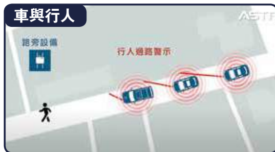
通過車輛與路旁設備的傳感技術，實時探測道路危險情況。
