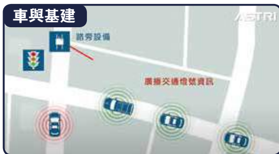
在道路基建上安裝車聯網設備後，可與車輛交換動態信息。
