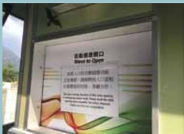
西貢南圍是其中一個設有太陽能鋁質垃圾收集站的地方，該垃圾收集站共設有十組投入口，正面各有一個紅外線自動感應活門，只要在投入口前揮手，原本緊閉的投入口閘門便會自動打開。
