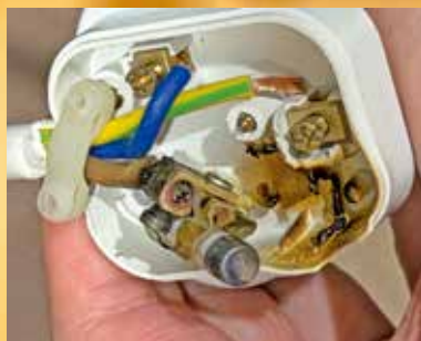
13A應以20A電的電器，被人以插頭直插插座中。
