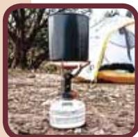
• 直立式的爐頭直接置於燃料罐上，構造簡單故較便宜。但使用大鍋時留意爐頭承托部分是否夠大以支撐，而爐腳站立的部分同樣要夠闊，令煮食爐平穩地站立。
