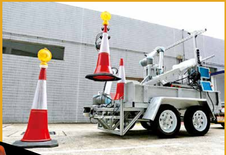
全球首個適合全港道路使用的智能機械臂系統。
