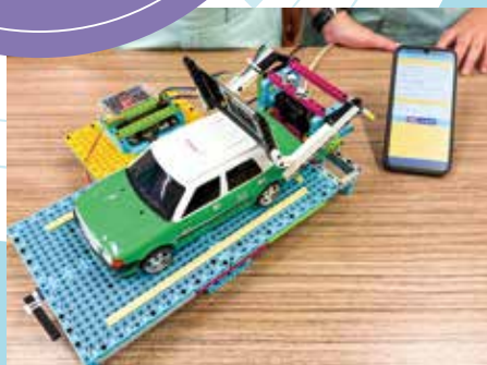
學生以NFC模擬「易通行」功能，測試車輛辨識及自動收費流程。
