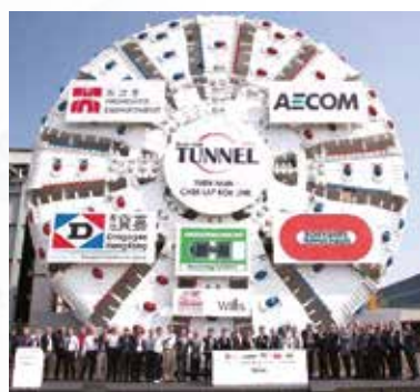
全球最大隧道鑽挖機「秦良玉」。
