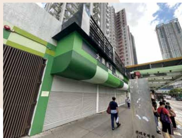
街市機房出風口被質疑散熱差，導致冷氣故障。
