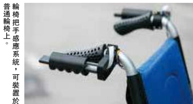
輪椅代步的長者，往往靠自己或照顧者手推車，即使路程短短，仍需花上不少氣力。就此，嶺南大學「嶺大創業行動」團隊研發一套「輪椅把手感應系統」，當中備有自動偵測功能，從而判斷輪椅推動者雙手的動作，以輔助動力驅動輪椅，讓照顧者毋須費勁便可輕易控制輪椅，保障輪椅使用者和照顧者的安全。
